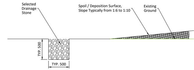
**FRENCH DRAIN / FILTER DRAIN**
